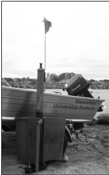
Abb. 8: Eingesetzte Messboje zur Untersuchung der Strömungen
