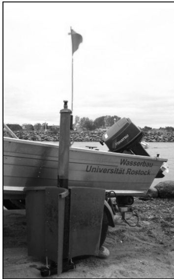
Abb. 8: Eingesetzte Messboje zur Untersuchung der Strömungen
