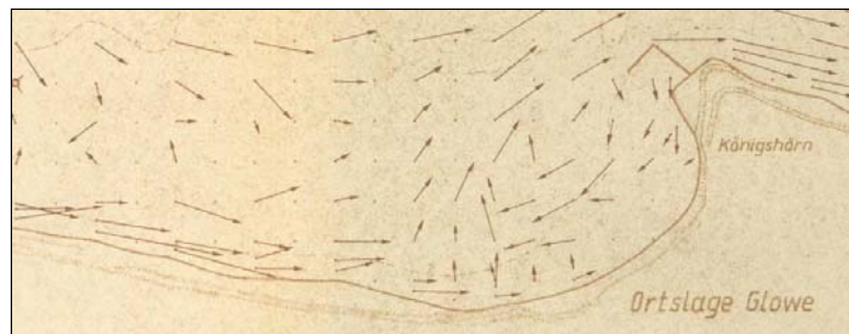
Abb. 7: Ergebnis von Modellversuchen zu küstennahen Strömungen in der Glowe-Bucht (Wellenanlauf aus Nordwest) durch Schinke (1968). In der Mitte der Bucht bildet sich aufgrund von Wasserstauwirkungen eine küstennormal ausgerichtete Nehrströmung. Dieses Strömungsmuster konnte durch die Naturmessungen nicht bestätigt werden.
